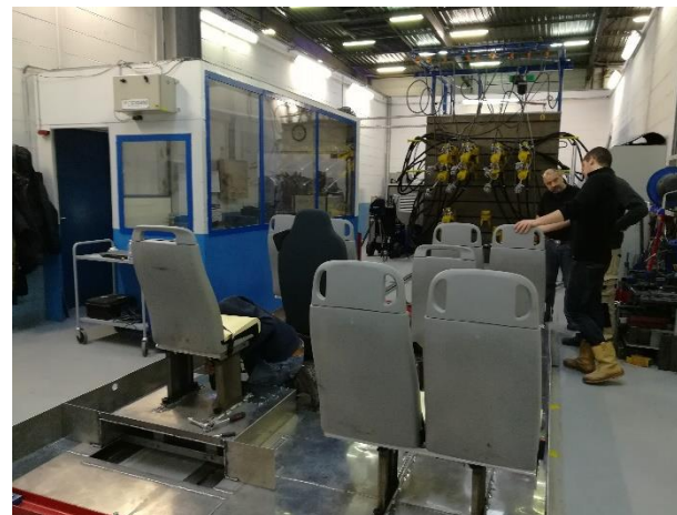
Essais d'ancre par catapulte sur une reproduction du plancher
