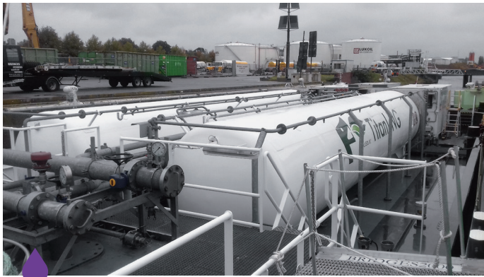
Réservoirs GNL, bateau «Ecotanker III», 110m x 11.40 m
